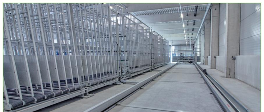
In der FeBa-Aluminiumfertigung wurde sowohl die Entkopplung der Elemente als auch die Abstapelung automatisiert.
